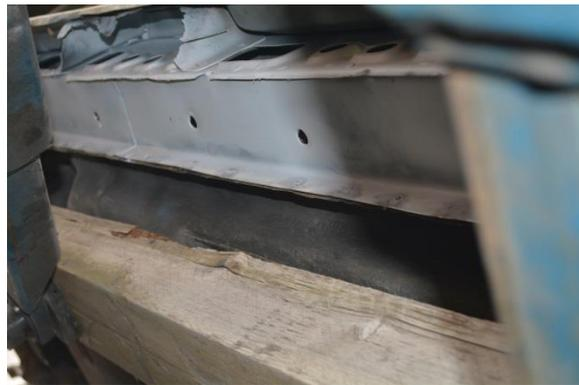
Nach dieser Arbeit wurde die gesamte Reparaturstelle mit Rostschutzgrundierung und Rostschutzlack lackiert. Nach Abtrocknung des Lackes wurde der Schweller angepasst und wieder im unteren Bereich gepunktet. Vorher wurde er auch auf der Innenseite mit Rostschutzgrund behandelt.
